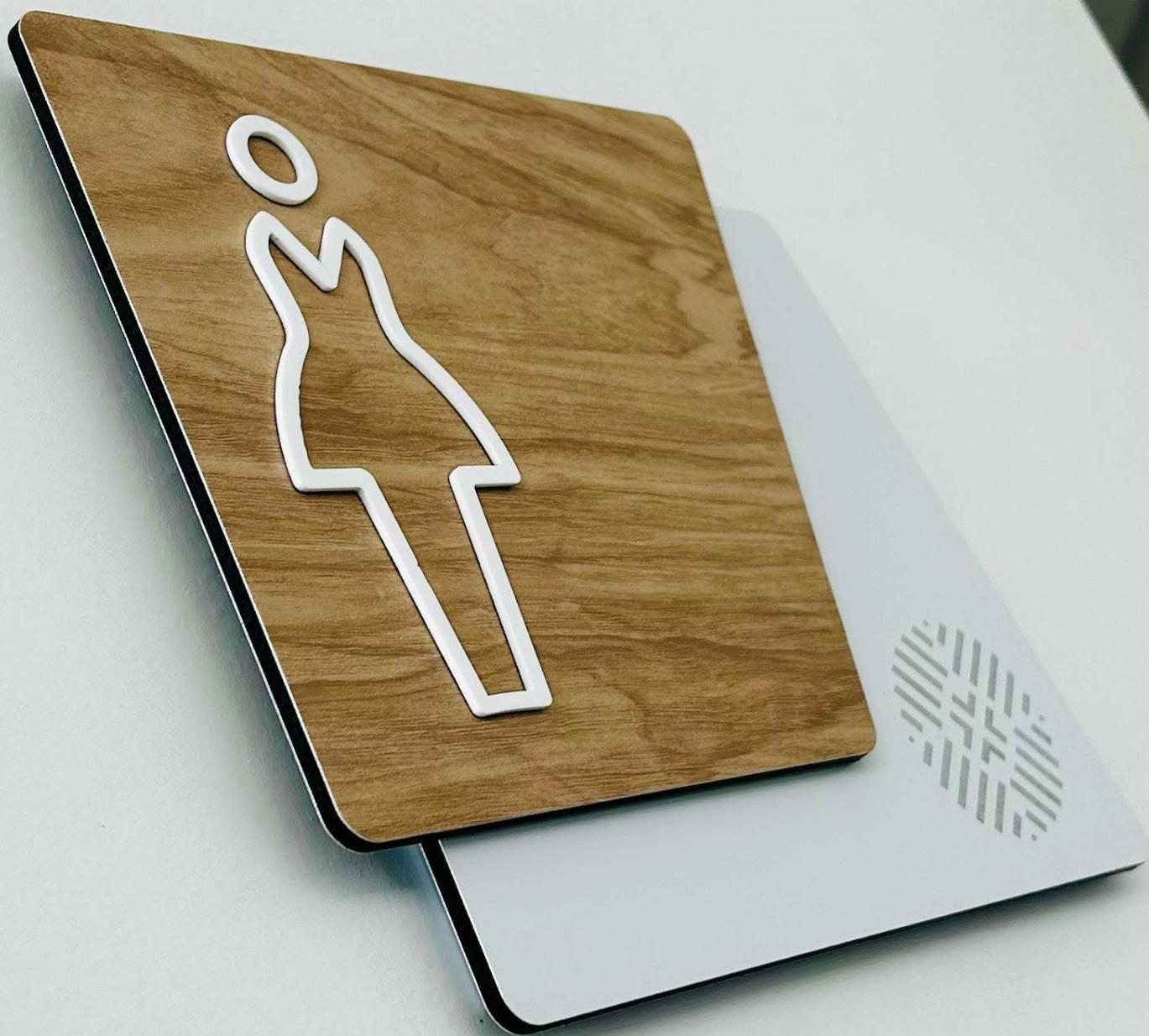
Artigo em três camadas: A.C.M. com gravação a laser na base, A.C.M. com adesivo vinílico com textura de madeira para camada central e acrílico cortado na laser para camada superior. Fixação por dupla face estrutural.
